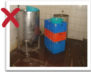
Figura 32: Ang mga lalagyan ng tubig na may kalawang at mga metal na dram ay hindi angkop sa paghuhugas ng mga materyales na magkakaroon ng kontak sa pagkain.
